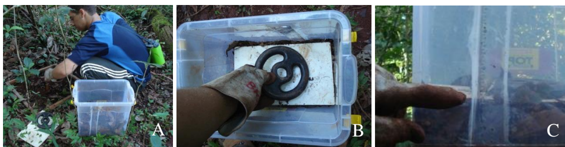
Figura 4.2 – Metodologia de Coleta de Serapilheira com caixa graduada. A – Delimitação da área de coleta para coleta da serapilheira. B – Uso do peso padrão de 2 Kg sobre a tampa de madeira. C – Medida da altura no serapilheira utilizando a régua graduada.
